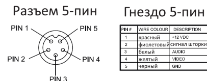
Распиновка M13 5-пин штекера камеры со шторкой ViSUM C-R-IR12 AS(CMOS)
